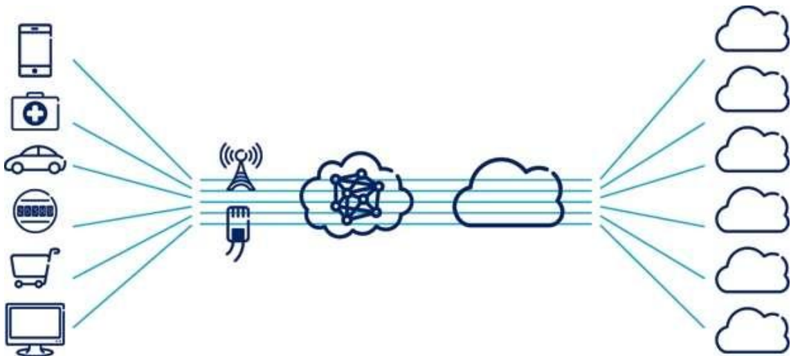
Obr. 14: Jednoduché schéma network slicing v 5G
